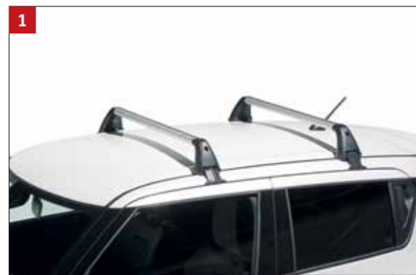
1 | Univerzálny strešný nosič 1 Hliníková rúrka s T-drážkou, uzamykateľná. Vlastná hmotnosť: 4,6 kg Maximálna hmotnosť nákladu na streche: 30 kg Obj. čís. 78901-53R00-000
